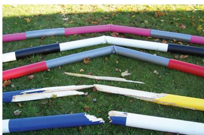
Comparaison entre une barre simple et une barre protégée par un tube en plastique qui ne laisse nuls éclats coupants.
