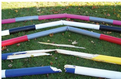
Vergleich zwischen einer einfachen Stange und einer mit Kunststoff umhüllten Stange, die keine spitzen Holzsplitter aufweist.
